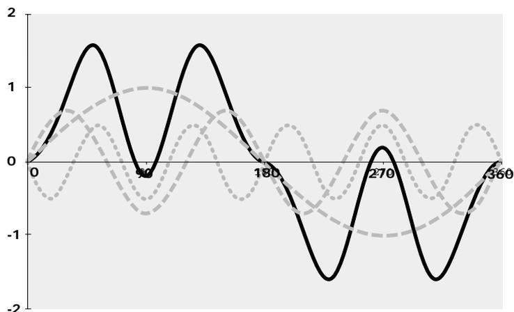
Figura 2 - Forma de onda de corriente distorsionada
