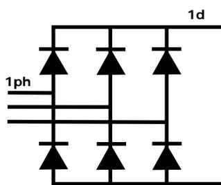
Figura 5 - Puente trifásico o de seis pulsos
