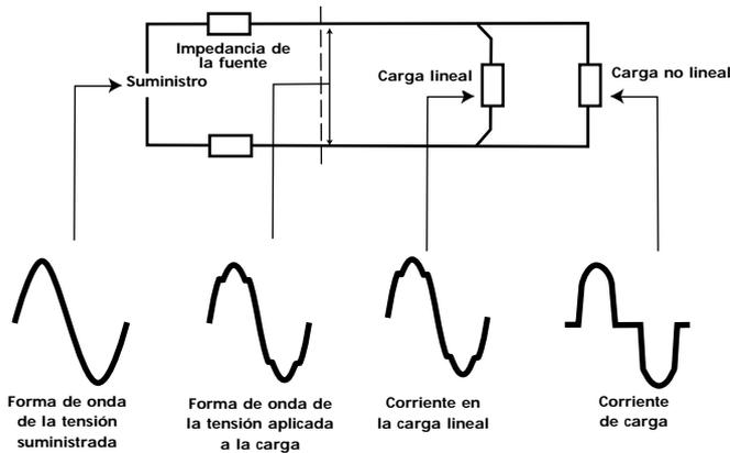
Figura 15 - Distorsión de la onda de tensión causada por una carga no lineal
