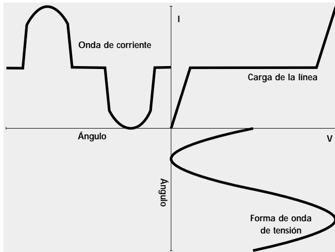
Figura 10 - Forma de onda de una carga no lineal
