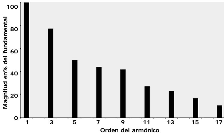
Figura 4 - Espectro armónico de una lámpara CFL
