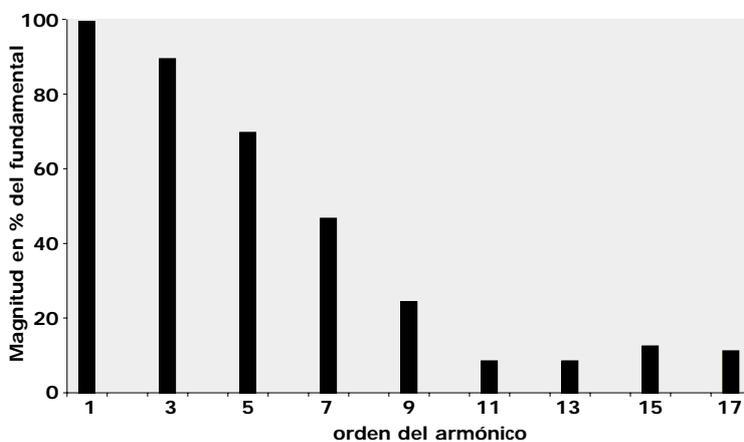
Figura 6 - Espectro armónico de un PC típico
