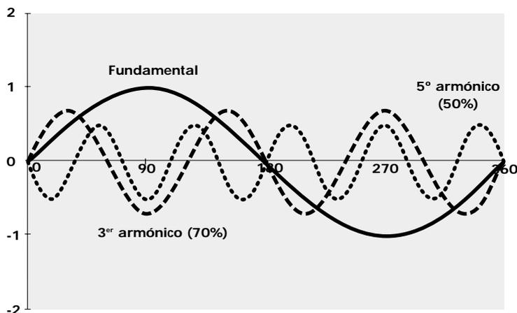
Figura 1 - Onda fundamental con 3º y 5º armónicos
