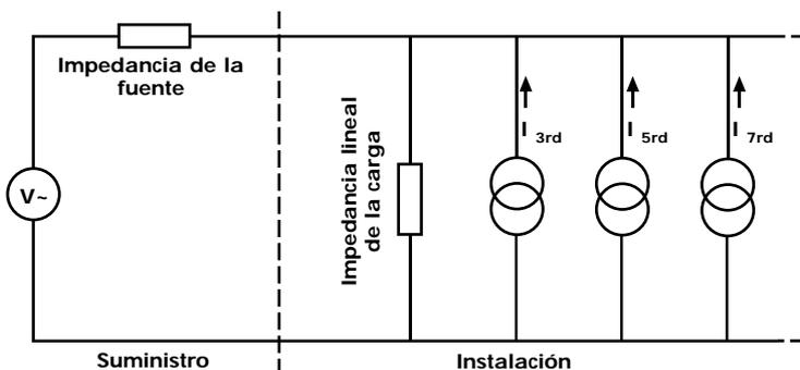
Figura 11 - Circuito equivalente de una carga no lineal
